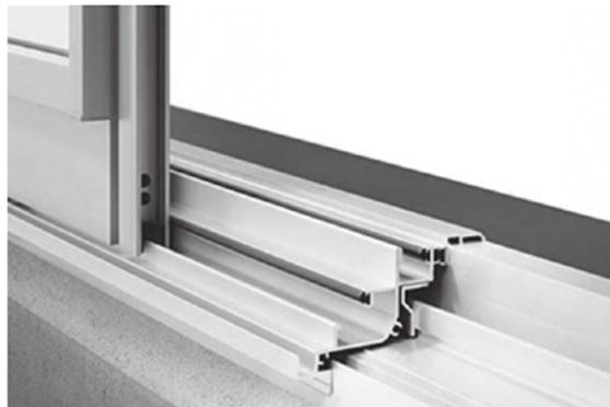
（特長）既存窓枠の下枠レールをカットして新設枠を接合することで、カバー工法より大きな開口寸法を確保することができる。またサッシ下枠部の段差を低減している。
