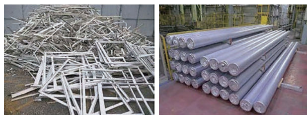
回収された仮設住宅の窓などに使われていたアルミ建材と再生されたアルミ素材
