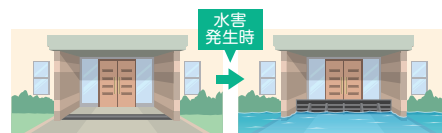
止水板の設置
