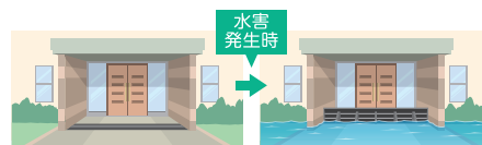
止水板の設置
