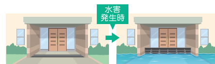
止水板の設置
