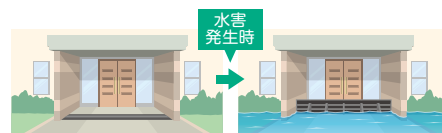
止水板の設置
