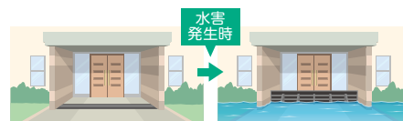
止水板の設置
